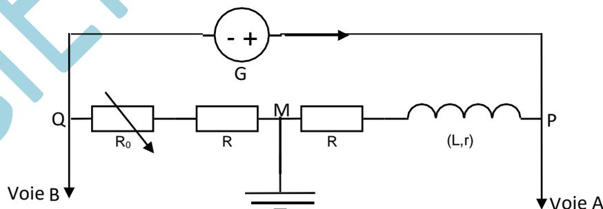
1. L'oscilloscope bi-courbe utilisé comporte une touche « ADD » permettant lorsqu'elle est actionnée, d'observer sur l'écran la tension  $u_{ADD}$  somme des tensions reçues sur les voies A et B :  $u_{ADD} = u_{PM} + u_{QM}$
